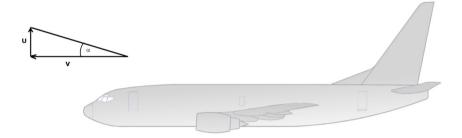
Trifft ein Flugzeug im Horizontalflug mit der wahren Geschwindigkeit V auf eine vertikale Böe der Geschwindigkeit U, so resultiert daraus eine plötzliche Änderung des Anstellwinkels  $\alpha$ . Es gilt für kleine Winkel  $\alpha$ :
